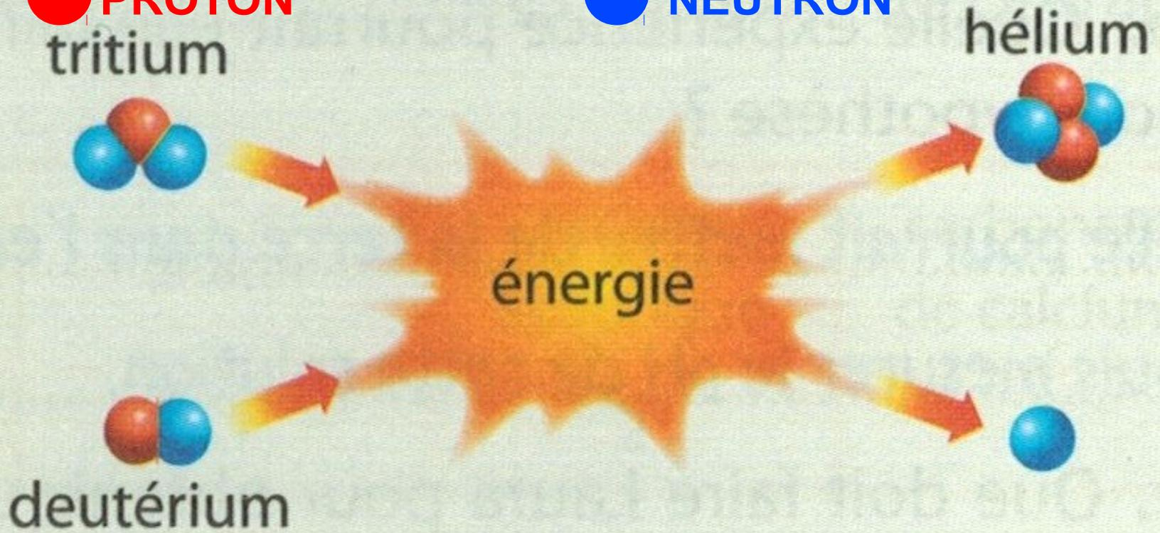
**Fig. 2** La réaction de fusion deutérium-tritium
