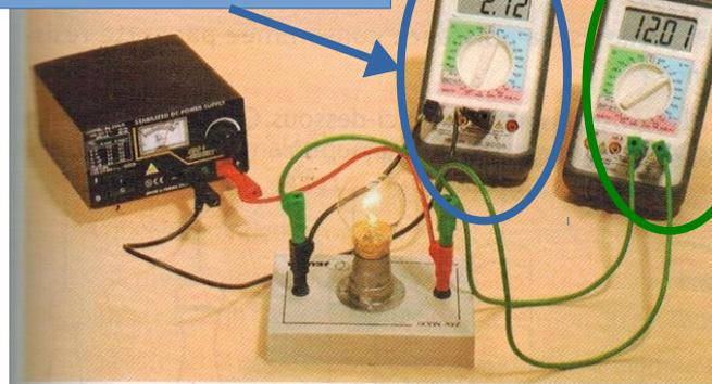
1. En utilisant les données de la photo, calculez la puissance électrique consommée par la lampe.
