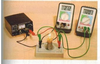
1. En utilisant les données de la photo, calculez la puissance electrique consommée par la lampe.
