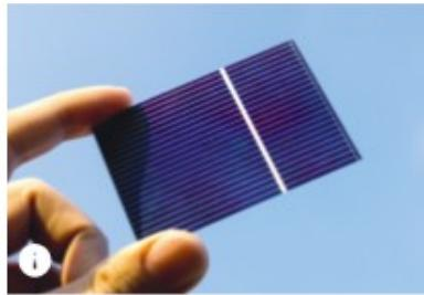
Éclairée par une source de lumière, une cellule photovoltaïque convertit l'énergie lumineuse en énergie électrique. L'énergie, transmise par les photons qui atteignent la cellule, provoque l'extraction d'électrons puis leur mise en mouvement dans le circuit.
