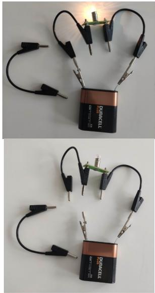
La **boucle** sur l'image est appelé **circuit électrique** et contient :
