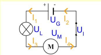
La tension aux bornes du générateur est égale à la somme des tensions aux bornes des récepteurs.  $U_G = U_L + U_M + U_I$
